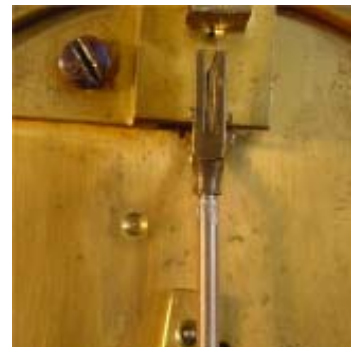
Unhook and remove the pendulum
